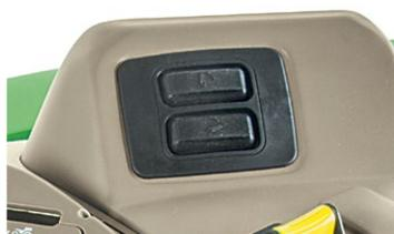
Il sistema di sollevamento elettrico ad abbassamento rapido (EQRL), ideale per le svolte a fine campo, permette di controllare senza sforzo gli attrezzi montati mentre il trattore è in movimento semplicemente agendo su un interruttore.
