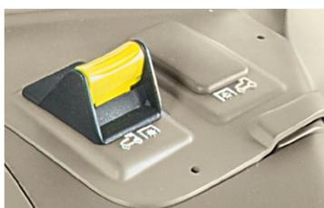
L'interruttore in cabina per la PTO elettroidraulica permette di controllare l'innesto e il disinnesto della PTO.
